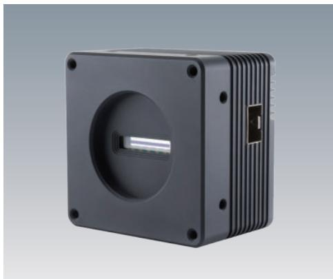
LCB-M02K10GF-L10K工业线阵相机,采用2048x32线TDI黑白ECCD Sensor,该Sensor同时兼具CCD TDI传感器的高灵敏度、高信噪比以及CMOS TDI传感器的高速度、低功耗的优点,代表业内最先进水平。除了普通相机版本之外,更是提供了NIR增强相机版本,用以适应更多的工业应用场景。
